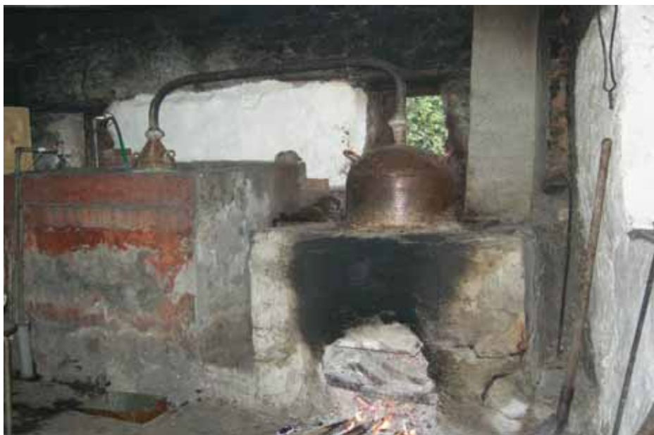
6.5 Εγκατάσταση καζανιού. (Καζάνι κ. Λαζάρου Εμμανουηλίδη).
