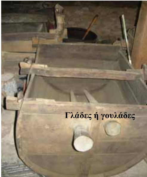
Εικ. 6.4 Πουστάβι, όπου οδηγούνται οι σωλήνες (γλάδες) με τους ατμούς της ρακής και ψύχονται. (Από την επισκέψιμη παραδοσιακή κατοικία του ζεύγους Χρήστου Τσιότσιου - Τατιάνας Ντέρου).
