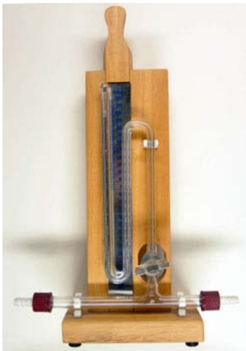
Εικόνα 4: Βαρόμετρο υδραργύρου κλειστού τύπου [Ander & Sonnessa 1973].
