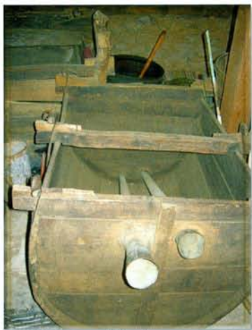
13.3 Πουστάβι, όπου οδηγούνται οι σωλήνες (γλάδες) με τους ατμούς της ρακής και ψύχονταν.
